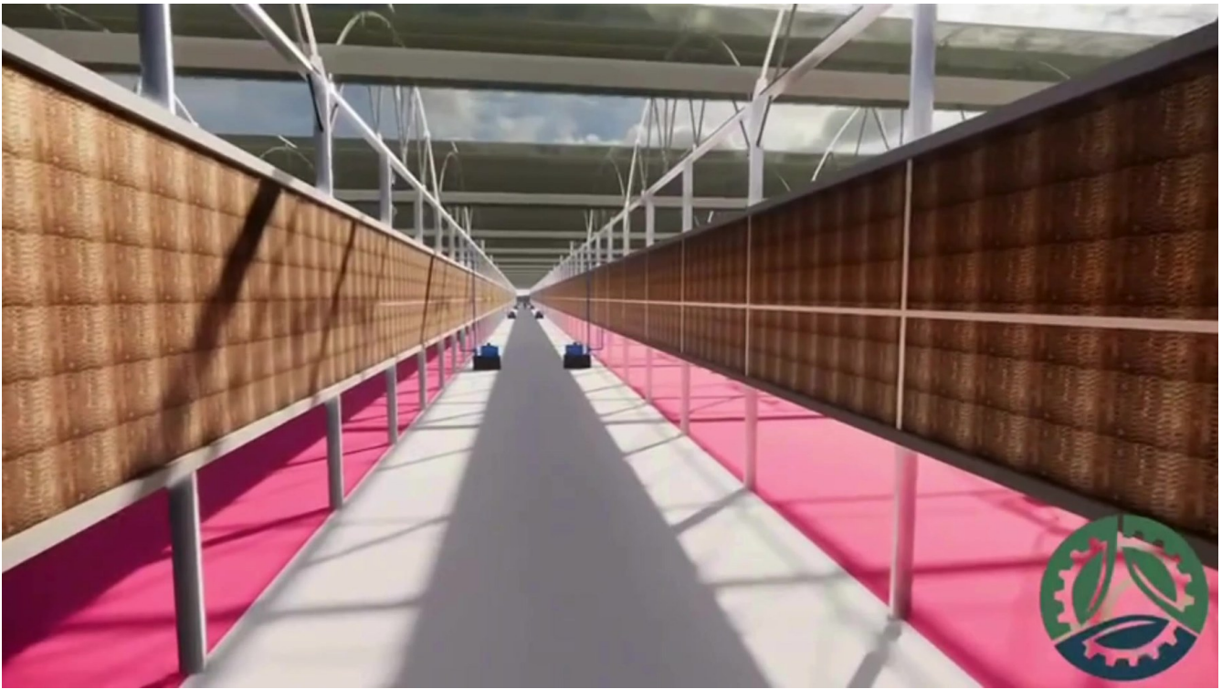
GREEN CLIMATE 3D sera tasarımında pad duvarı ve bakım koridoru.
